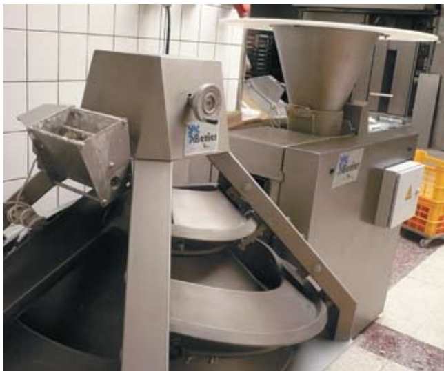
■ Kwasoodporne komory w dzielarce i kwasoodporna powłoka teflonowa w zaokrąglarce to atuty holenderskiego Beniera.
