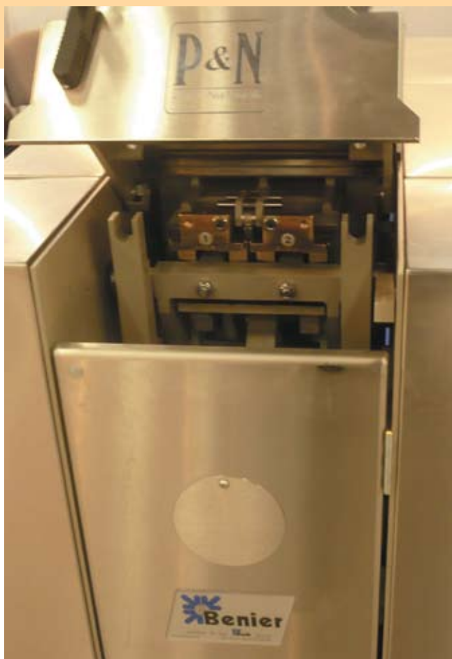
■ Benier DAM – dzielarka 2-komorowa wyposażona w tzw. „miękkie amortyzatory” dla luźnych ciast szczególnie wrażliwych na męczenie.
