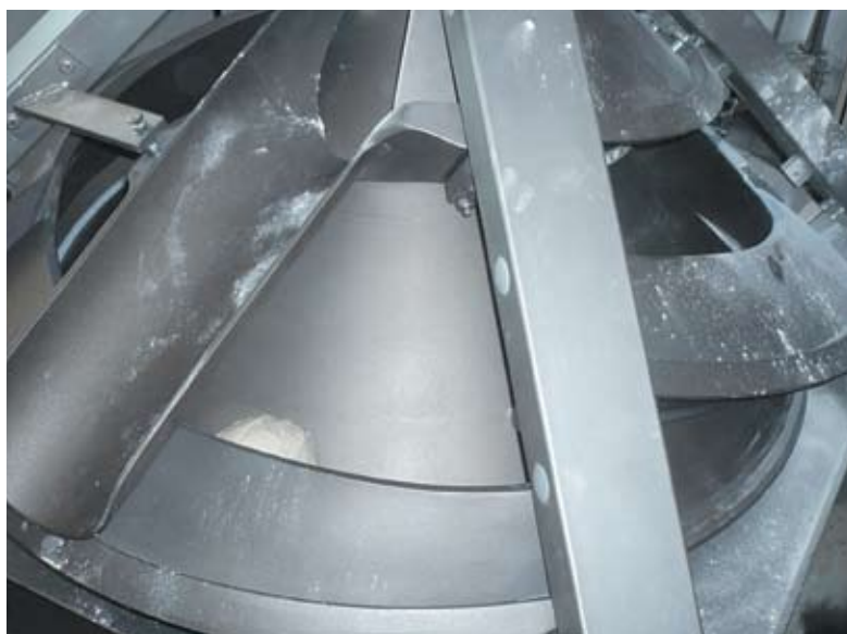
■ Zaokrąglarka Benier Allround - „urwana” rynnna pozwala rozpocząć formowanie „od nowa” i ukryć śluzę.
